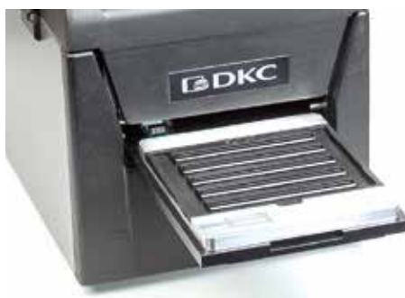
Установить адаптер на направляющий шпунты
