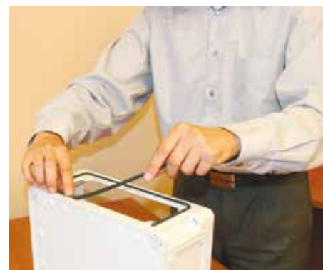
3. Установите уплотнитель на оба объединяемых корпуса
